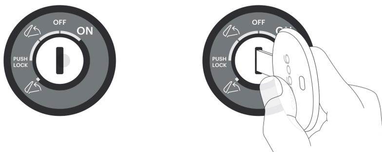
機械式鑰匙車種僅可使用傳統的機械式鑰匙，無法使用無線、非接觸式的開、關機方式。
