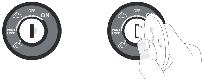
對於習慣傳統機車的使用者，Gogoro 部分車系提供使用傳統機械式鑰匙的車種選擇。只要把鑰匙插入主開鎖孔內轉動，即可上解鎖、開關系統電源或開啟座墊，不必改變以前的使用習慣。
