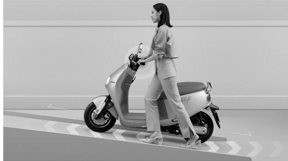
省力牽車模式，可以讓車子微速前進，方便您在不適合騎車的場所下車牽行。
