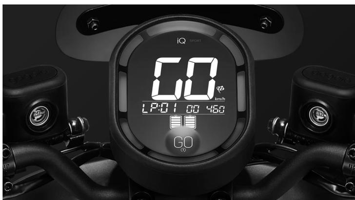
當您在賽道練習時，可使用碼錶模式，以便在儀表板上顯示每一單圈的攻略時間。碼錶顯示記憶容量，最大可達 30 圈，超過則循環從第一圈開始。每圈最大可達 99 分 59 秒，超過則自動計入下一圈。
