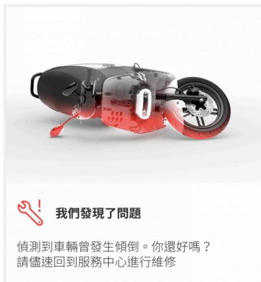
若 Smartscooter® 智慧電動機車在「系統電源已開啟」狀態下意外傾倒，且使用者未進行操作下數秒，系統會自動斷電，以策安全。
