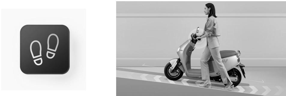
省力牽車模式，可以讓車子微速前進，方便您在不適合騎車的場所下車牽行。
